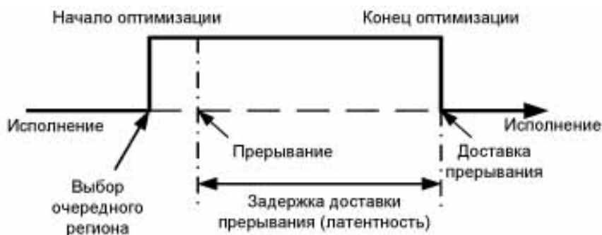
Рис. 5. Задержка реакции системы на внешнее прерывание, обусловленная фазой оптимизирующей трансляции.
