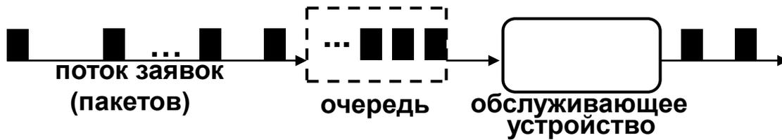
Принципиальная схема процессов, определяющих уровень QoS в сетевом узле коммутации: поступление потока заявок (пакетов) на обработку обслуживающим устройством (процедурой узла) с вероятностью образования входной очереди. Интервалы поступления и обслуживания характеризуются случайными величинами
