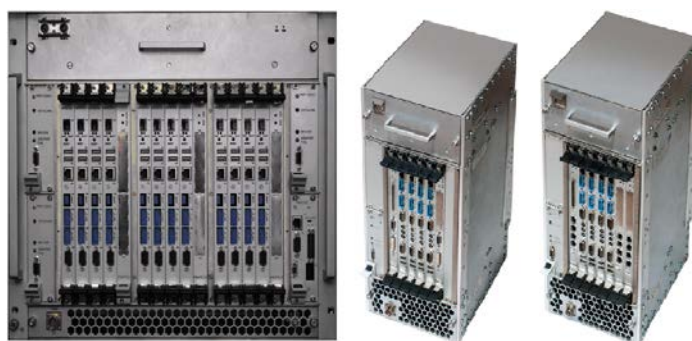
Рисунок 7. Многопроцессорные системы С-1, С-2 и С-3 на основе унифицированного однопроцессорного вычислительного модуля, соответствующего стандартам VPX
