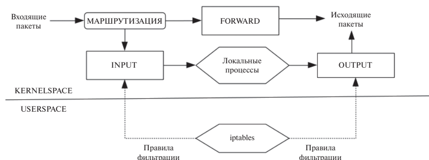
Рисунок 2. Схема фильтрации межсетевого экрана Netfilter
