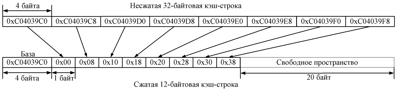
Рисунок 1. Сжатие кэш-строки по алгоритму V+Δ с одной базой
