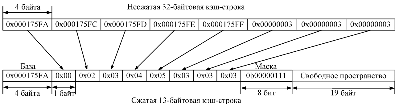
Рисунок 2. Сжатие кэш-строки по алгоритму BΔI
