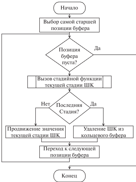
Рисунок 4. Упрощенный алгоритм моделирования конвейера
