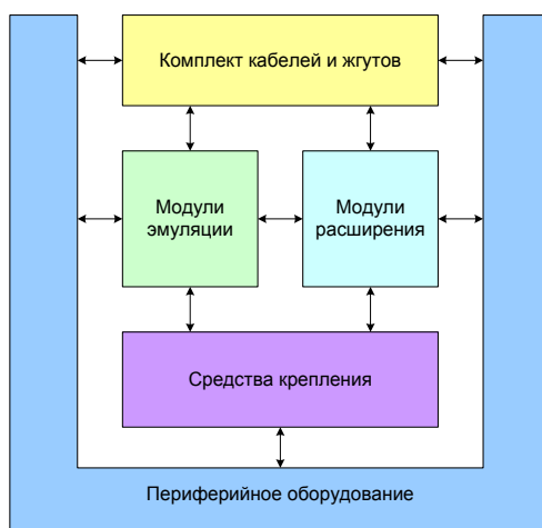
Рисунок 4. Схема аппаратного состава масштабируемой системы эмуляции.
