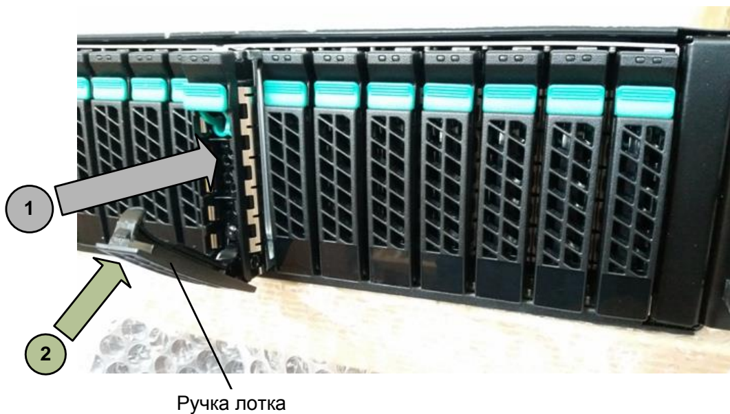
Рисунок 11 – Монтаж накопителя SSD
